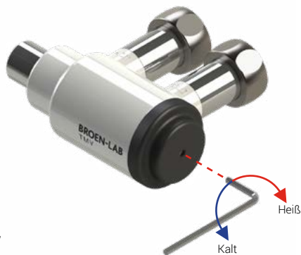
Abbildung 3: Temperatureinstellung von TMV
